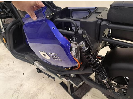
Ota istuimen vasemmanpuoleinen alasisivumuovi pois.
