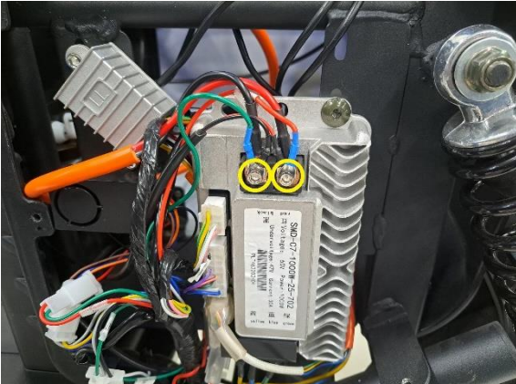
Irrota virtajohtojen kiinnityspultit (kuusiokoloavain 4 mm).
