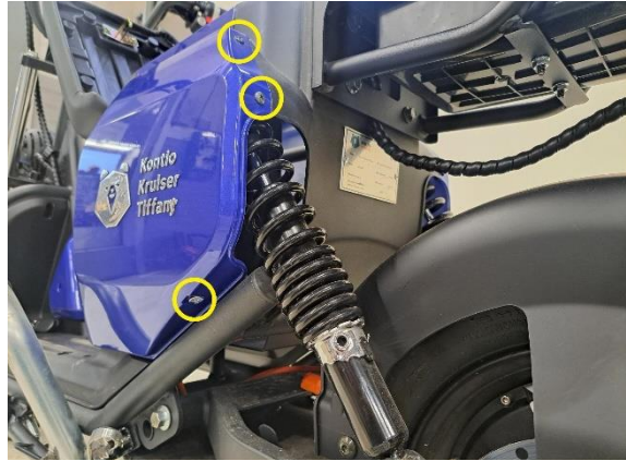
Irrota istuimen vasemmanpuoleisen alasisivumuovin kiinnitysruuvit (ristipäämeisseli ph2).
