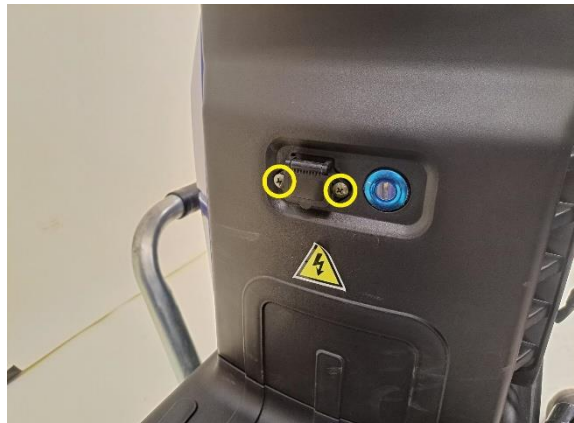
Irrota ulkoisen latauspistokkeen kiinnitysruuvit (ristipäämeisseli ph2).
