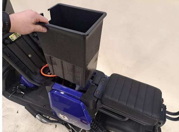
Nosta akkukotelo pois.
