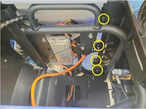
Irrota istuimen vasemmanpuoleisen alasisivumuovin kiinnitysruuvit (ristipäämeisseli ph2).
